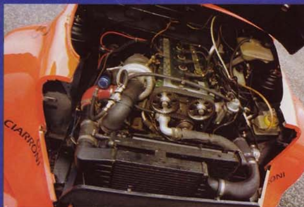
L'alloggiamento del motore Cosworth YF è anteriore longitudinale, in perfetta antitesi con il posteriore trasversale della 500 di serie...
